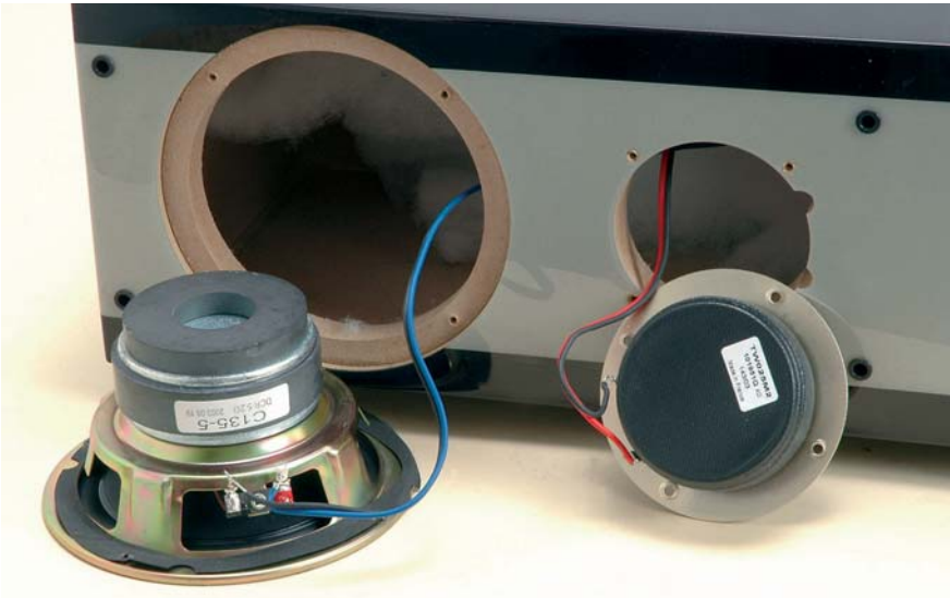
La foto mostra il midrange (a doppio magnete contrapposto per uso audio-video) ed il bel tweeter a cupola morbida di provenienza dichiarata Audax estratti dal baffle frontale.
