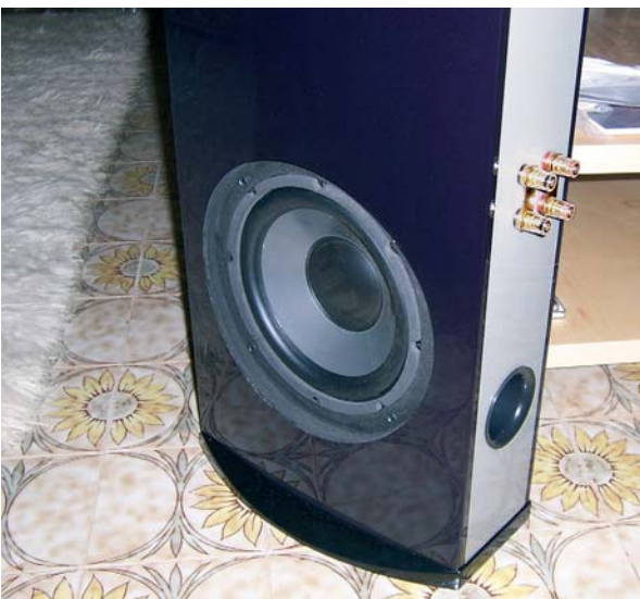
Immagini del woofer laterale e degli eccellenti morsetti di collegamento atti al bi-wiring delle CAV Audio.
