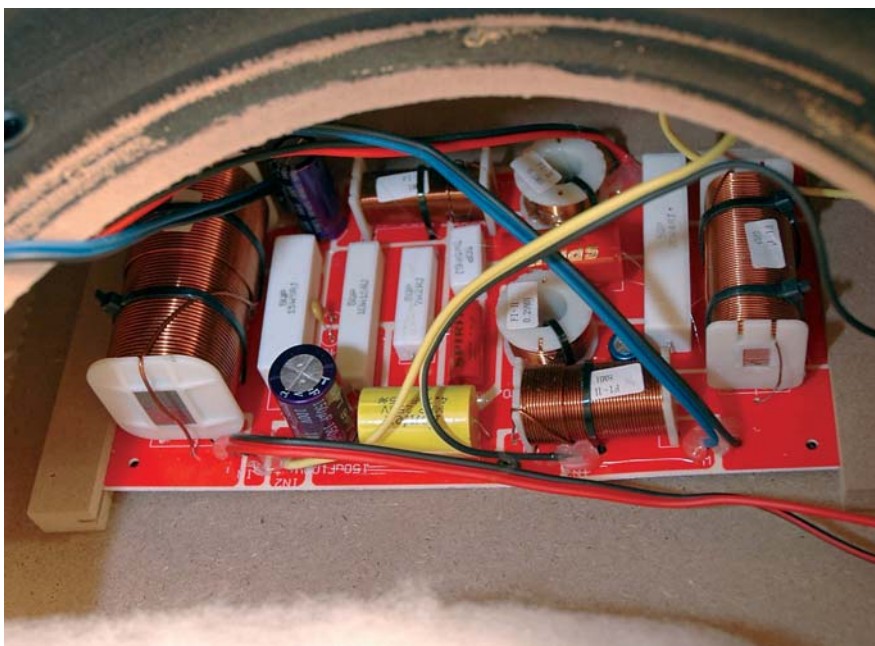
Il complesso circuito dei filtri di crossover con numerosi componenti e di buona qualità.
